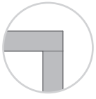
Korpuskonstruktion oben bei Einzel- und Aufsatzschrank
