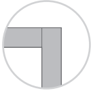
Korpuskonstruktion oben bei Unter- und Zwischenschrank
